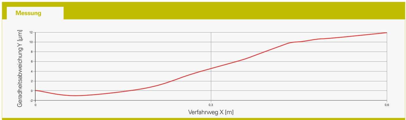
Ausgangsmessung: Der rote Graph zeigt die gemessene Gesamt-Positionsabweichung in Geradheitsrichtung ohne Berücksichtigung von Kalibrierdaten.
